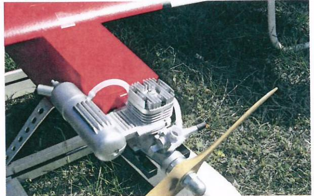
Bei diesem Ugli Stick deutete Besitzer Attilio di Girolamo auf den OS mit Schalldämpfer und sagte immer wieder »Plastik!« Tatsächlich war dies eine täuschend echte Kunststoff-Attrappe; dahinter im eigentlichen Tankraum saß der E-Antrieb mit nach vorn durchgehender Propellerwelle. Das Fertigmodell kostet mit Antrieb lediglich rund 80 Euro, die Schwimmer sind Styro-Eigenbau.
