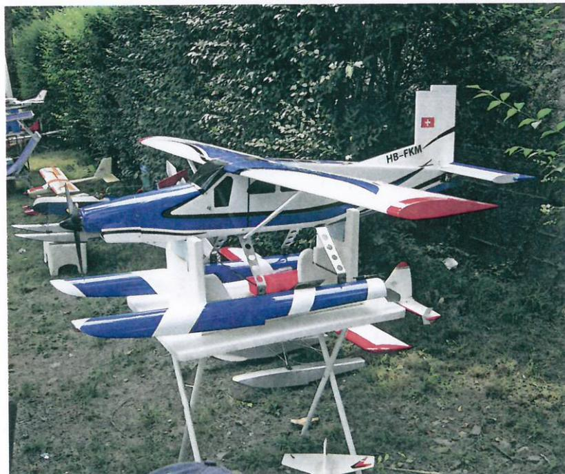
Der schweizer Kollege Roberto della Chiesa war mit einer sehr schönen Pilatus Porter aus dem Hause PAF angereist. Der 195 m spannende und 5 kg schwere Hochdecker wurde mit Eigenbau-Schwimmern zum Wasserflugmodell aufgewertet, perfekt elektrisch angetrieben durch einen Hacker-50 mit 6s-LiPos und einer Dreiblatt 17x8.
